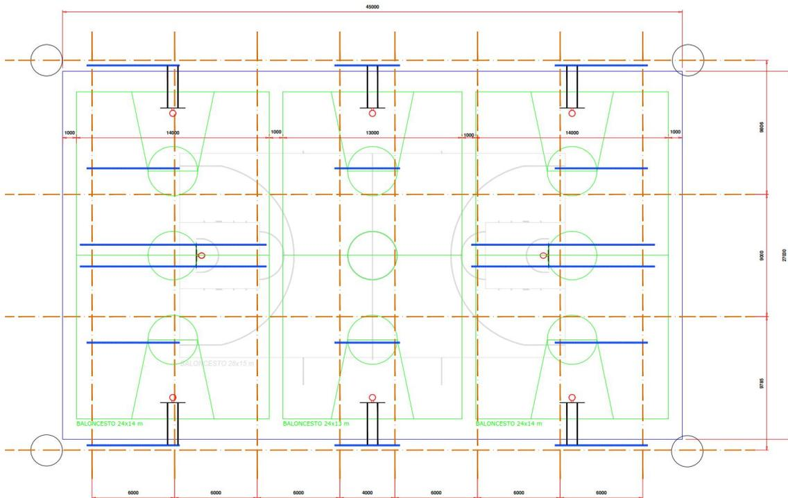
De color verde aparecen las pistas de entrenamiento, de color gris la pista principal, de color naranja la proyección de la estructura de cubierta y de color azul la estructura auxiliar de soporte de las canastas.
