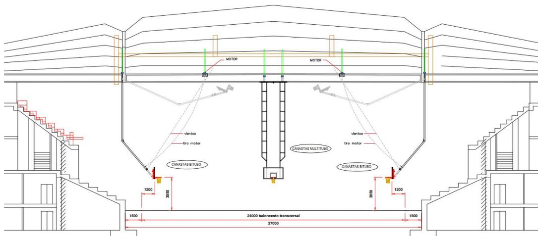
Como se observa en la imagen anterior se proponen para las pistas de entrenamiento unas canastas suspendidas desde los arcos principales y abatibles hacia el interior de la pista y accionadas por motores eléctricos ubicados sobre una estructura metálica auxiliar que cuelga de las cerchas centrales.
