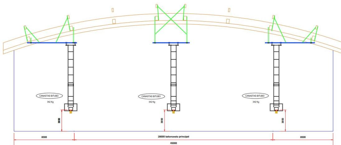
Para la pista central se propone un juego de canastas suspendidas y retráctiles, pivotando hacia el exterior de la pista y accionado igualmente por un motor eléctrico. Con el objeto de arristrar las canastas una vez desplegadas se dispone un codal posterior plegable (FIGURA 4):
