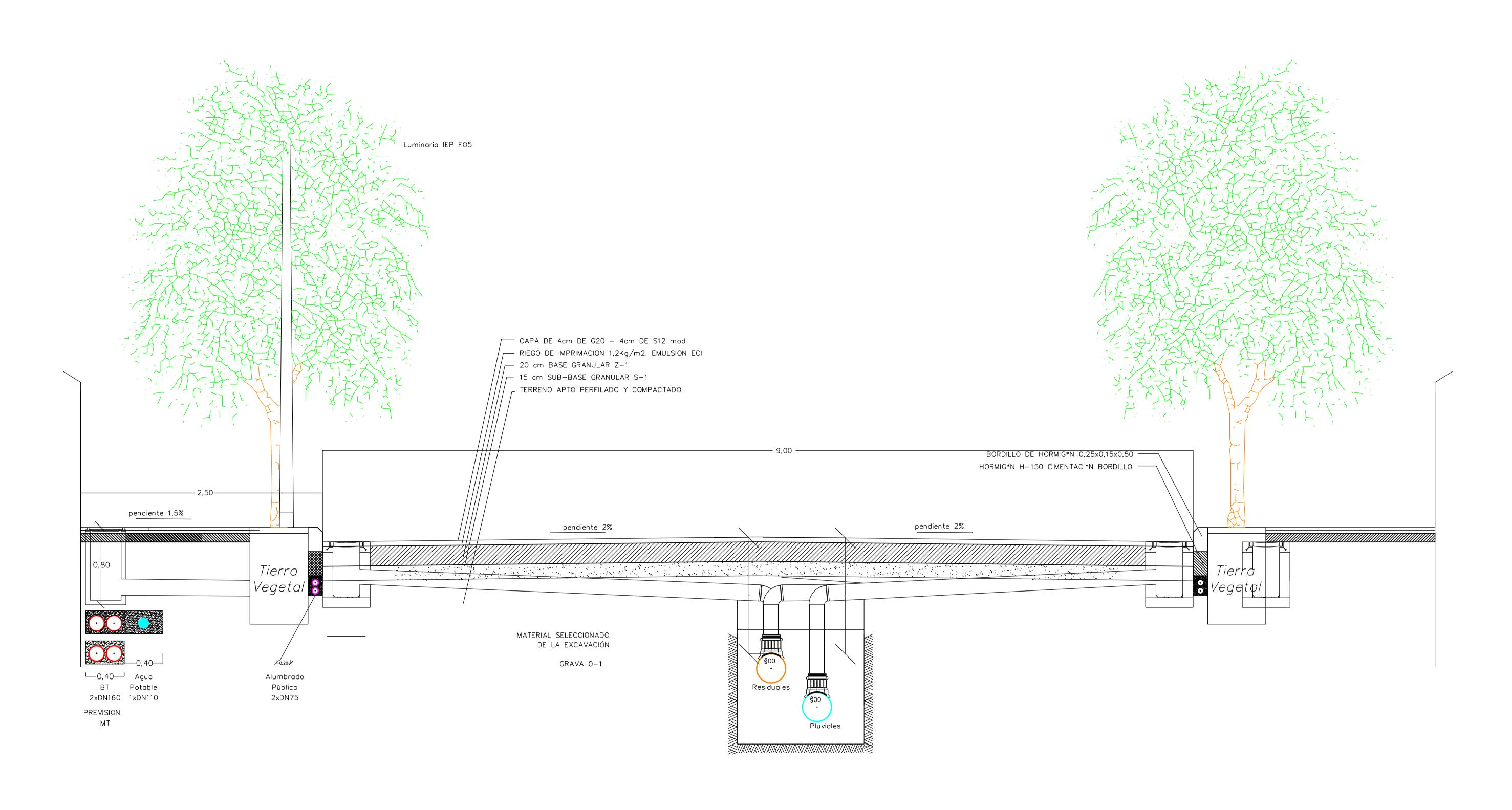
Nota: se instalara cinta señalizadora, normalizada por la compañia suministradora, en todos los servicios. Para los servicios de agua o gas, que no van hormigonados, cuando puntualmente discurran por lugares como debajo de Pozos de Bloqueo o Arquetas de otros servicios, se instalaran dichos servicios en el interior de VAINAS.
