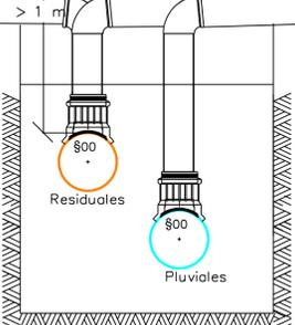
Nota: se instalara cinta señalizadora, normalizada por la compañía suministradora, en todos los servicios. Para los servicios de agua o gas, que no van hormigonados, cuando puntualmente discurren por lugares como debajo de Pozos de Bloqueo o Arquetas de otros servicios, se instalaran dichos servicios en el interior de VAINAS.
